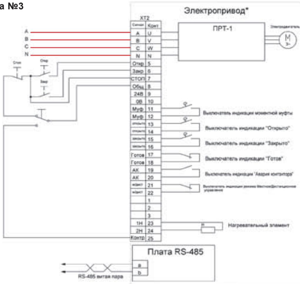
\* Положения выключателей соответствуют нахождению привода в среднем положении в состоянии готовности к работе в режиме дистанционного управления.
