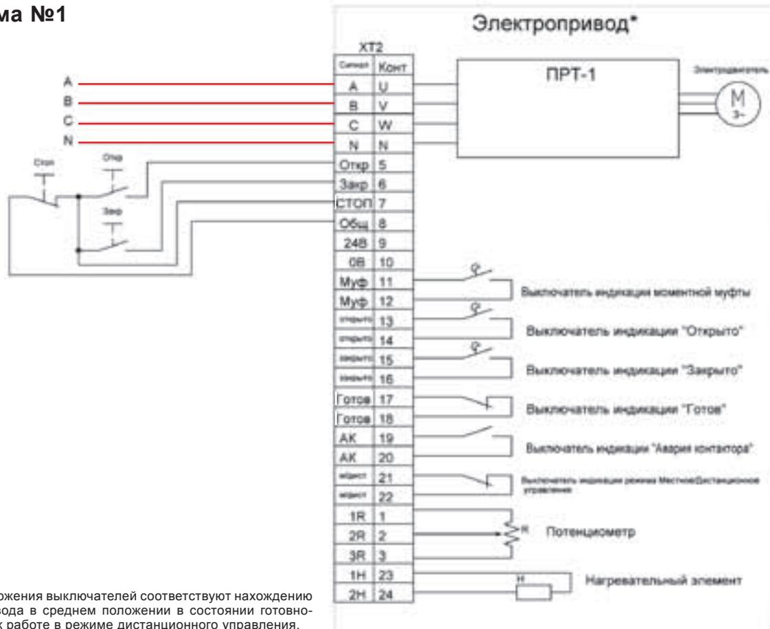
\* Положения выключателей соответствуют нахождению привода в среднем положении в состоянии готовности к работе в режиме дистанционного управления.
