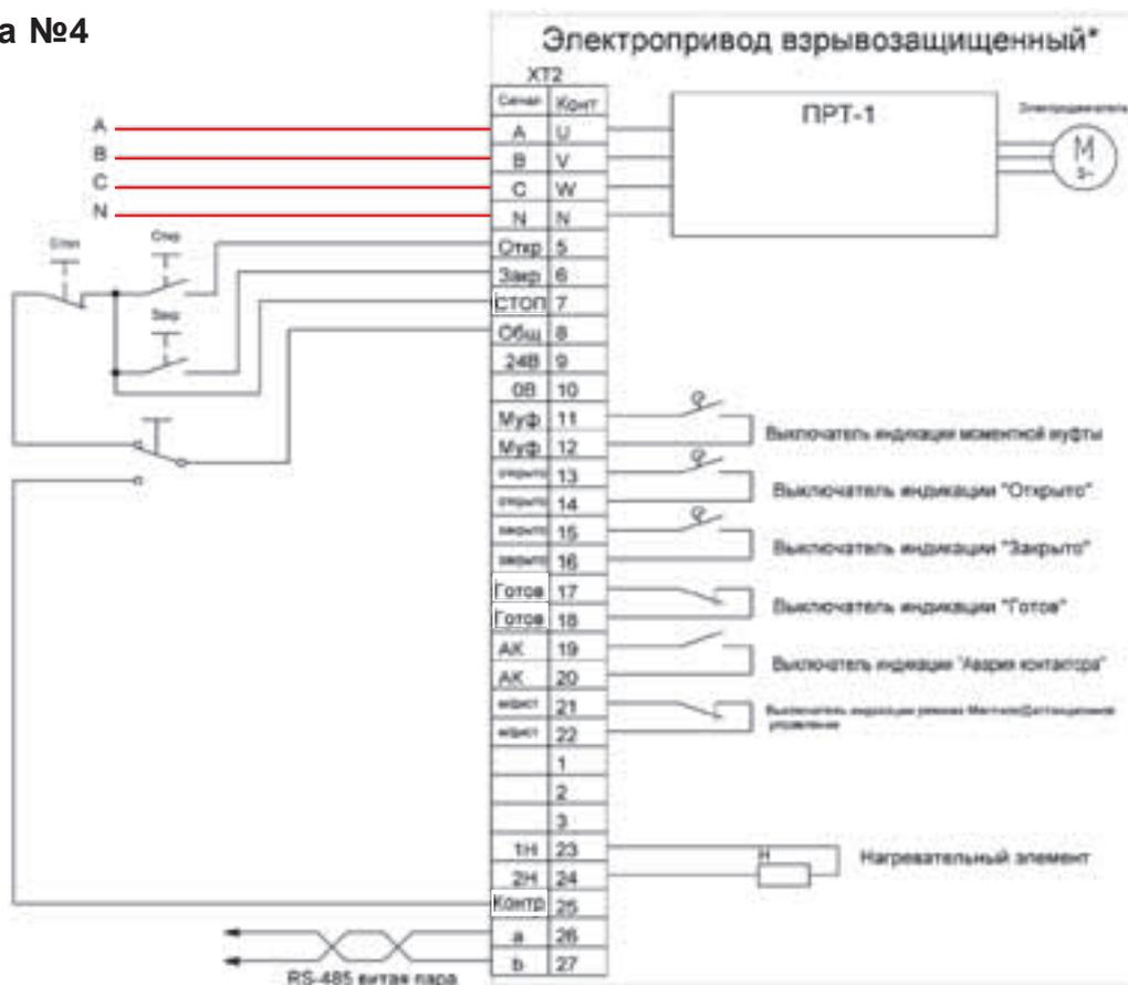
\* Положения выключателей соответствуют нахождению привода в среднем положении в состоянии готовности к работе в режиме дистанционного управления.
