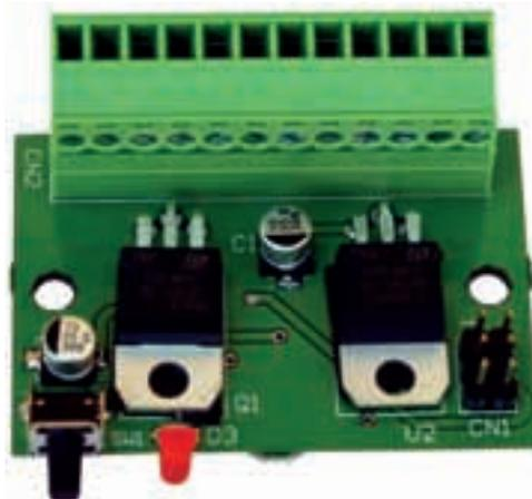
**2. Точковые датчики различных модификаций** – необходимы для преобразования омического сигнала от потенциометра электрической схемы электропривода в унифицированный точковый сигнал 4-20 мА. Точковый сигнал 4-20 мА (так называемая “точковая петля”) используется для контроля положения электропривода.
